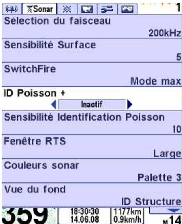
**Sélection du faisceau** : choisir **l'option 200** qui présente un faisceau étroit représentant par exemple un cercle de 10 m de diamètre à 30 mètres de profondeur (cercle d'environ 1 / 3 de la profondeur). L'option 83 offre un faisceau large qui permet de visualiser les poissons évoluant loin du bateau : option à utiliser si vous pêchez dans moins de 12 m de profondeur
