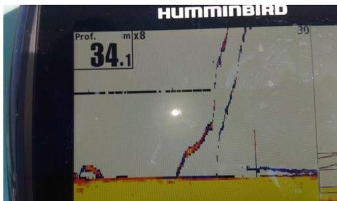
On voit le poisson monter d'environ 1.5 m (trait coloré), puis monter rapidement, tracé par l'hameçon (le trait est moins épais, le poisson monte vite et est moins détecté par le sondeur). L'autre trait est celui du plomb.
