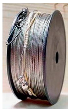
Le fil de ligne, un câble en acier, gainé par du nylon :
